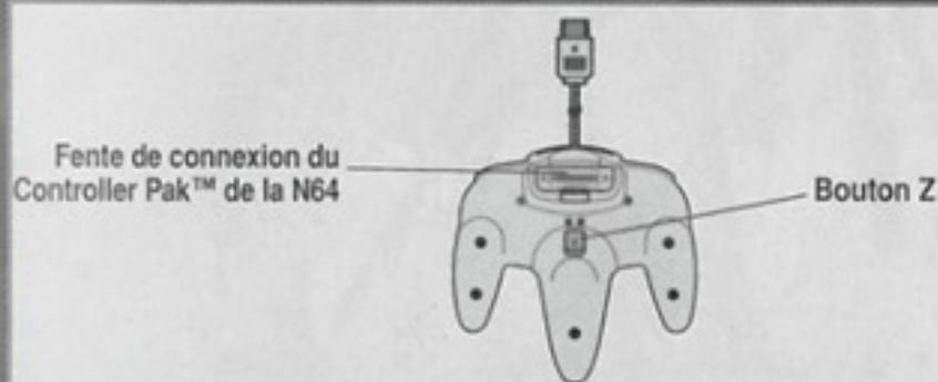
La manette de la Nintendo 64 contient un levier de contrôle qui utilise un système analogique pour la lecture des angles et de la direction de ses mouvements. Un tel système permet un contrôle dont la subtilité dépasse de loin celle d'une manette conventionnelle.
